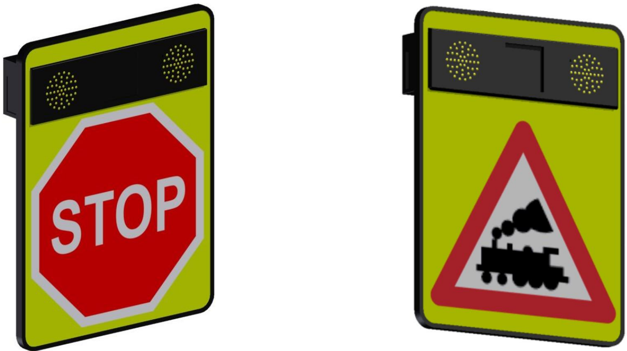
Različna motiva opozorilnega sistema COPS@rail – znak 2102 (STOP) za postavitve neposredno pred prehodom in 1202 (nezavarovan prehod ceste čez železniško progo) za postavitve na razdalji 80 m od prehoda
